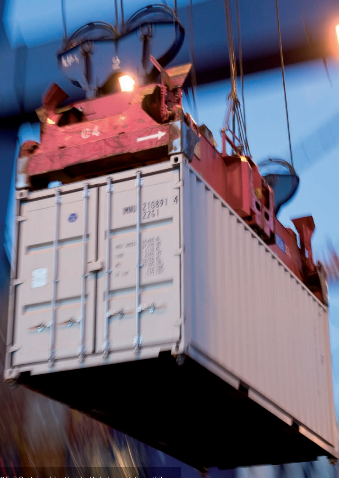
Ein 20 Fuß Container hängt bei der Verladung in luftiger Höhe am Spreader , dem typischen Containerverladegeschirr.
